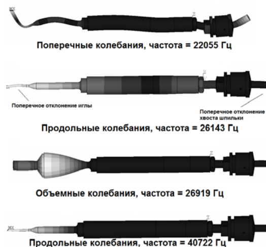
Рис.3. Наблюдаемые типы колебаний волновода. Степень яркости говорит о величине смещения – чем ближе к белому, тем больше величина смещения в процессе колебаний
